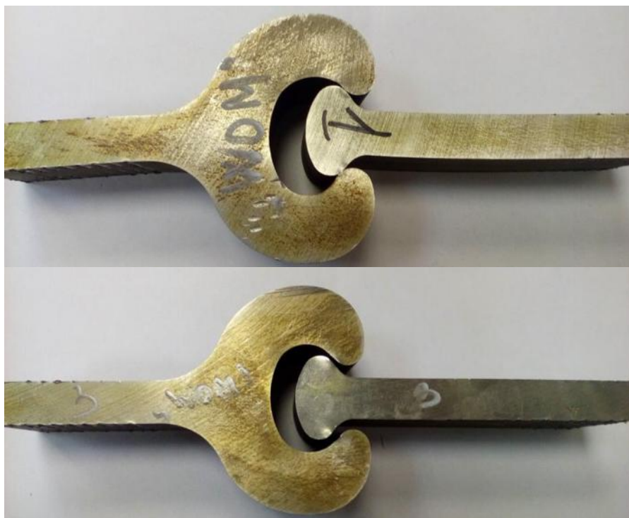
Рис.3. Вид формы образцов после пикового усилия растяжения.
